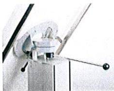
Der Grosse Bedienungshebel rechts ist für die Kippvorrichtung, und der kleine Hebel links ist für die Drehvorrichtung angebracht. Die Bedienung der Kippvorrichtung ist oben beschrieben. Um die Drehvorrichtung zu lösen drücken Sie den kleinen Hebel nach hinten. Die Tischplatte kann nun nach Belieben gedreht werden. Um die Tischplatte festzustellen ziehen Sie den kleinen Hebel nach vorn. Beide Hebel sind in Achsrichtung des Klemmgewindes ausrückbar und können dadurch jederzeit verstellt werden.
