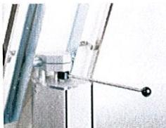
Die Bedienungsseite des Tisches ist auf der Seite des Fusschalters. Um die Tischplatte festzustellen drücken Sie den Bedienungshebel nach hinten. Für den Kippvorgang ziehen Sie den Bedienungshebel nach vorn. Die Tischplatte kann im gewünschten Neigungswinkel positioniert und festgestellt werden. Der Bedienungshebel ist in Achsrichtung des Klemmgewindes ausrückbar und kann dadurch jederzeit verstellt werden.
