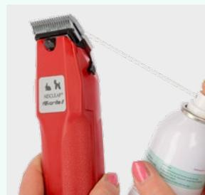
Für das Ölen zwischen den Schermessern eignet sich auch sehr gut ein Ölspray mit einem Röhrchen als Aufsatz. Damit wird noch mehr Druck erzeugt und das Öl besser zwischen den Messern verteilt.
